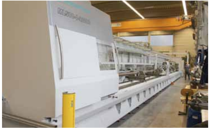
Bild 2: Die Bearbeitung der Schleudergussrohre erfolgt auf einer Tiefbohrmaschine der ML-500-Serie.
