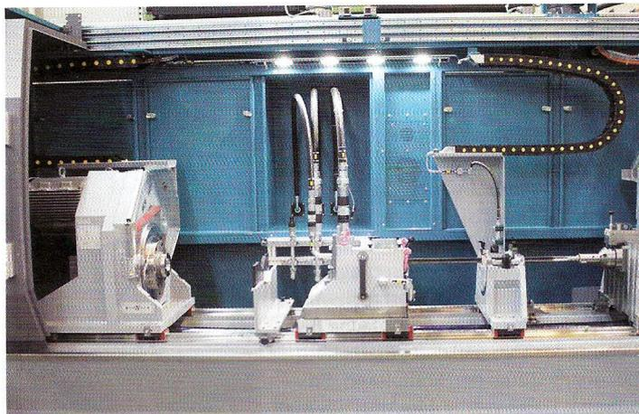
Eine Tiefbohrmaschine für zwei Technologien: Die „ML300ELB/STS“ lässt sich schnell umrüsten, zum Beispiel für Einlippen- und STS-Werkzeuge.
