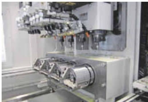
Die Querbohrreinheit der Kombimaschine für Radialbohrungen bei Getriebewellen
