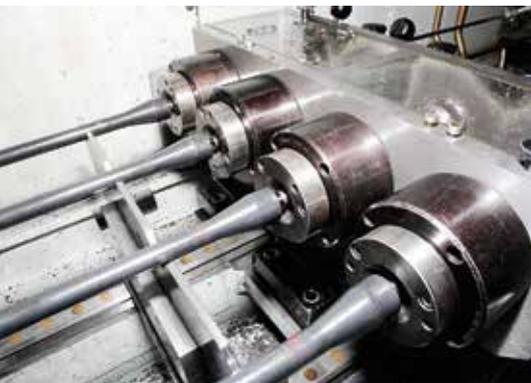
**3 Bohren von Gesteinswerkzeugen auf einer vierspindligen Tiefbohrmaschine. Die Bohrtiefen betragen bis zu 1300 mm; gespannt wird mittels Spannkronen** (Bild: TBT)
