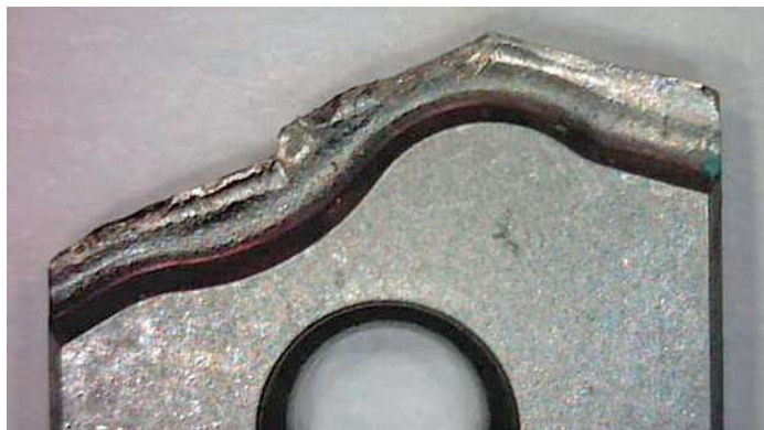
Nach der Bearbeitung in Test 1 mit einer Schnittgeschwindigkeit von 60 m/min waren an der Span- und der Freifläche der Schneide deutlicher Kolkverschleiß und teilweise Aufbauschneidenbildung festzustellen.
