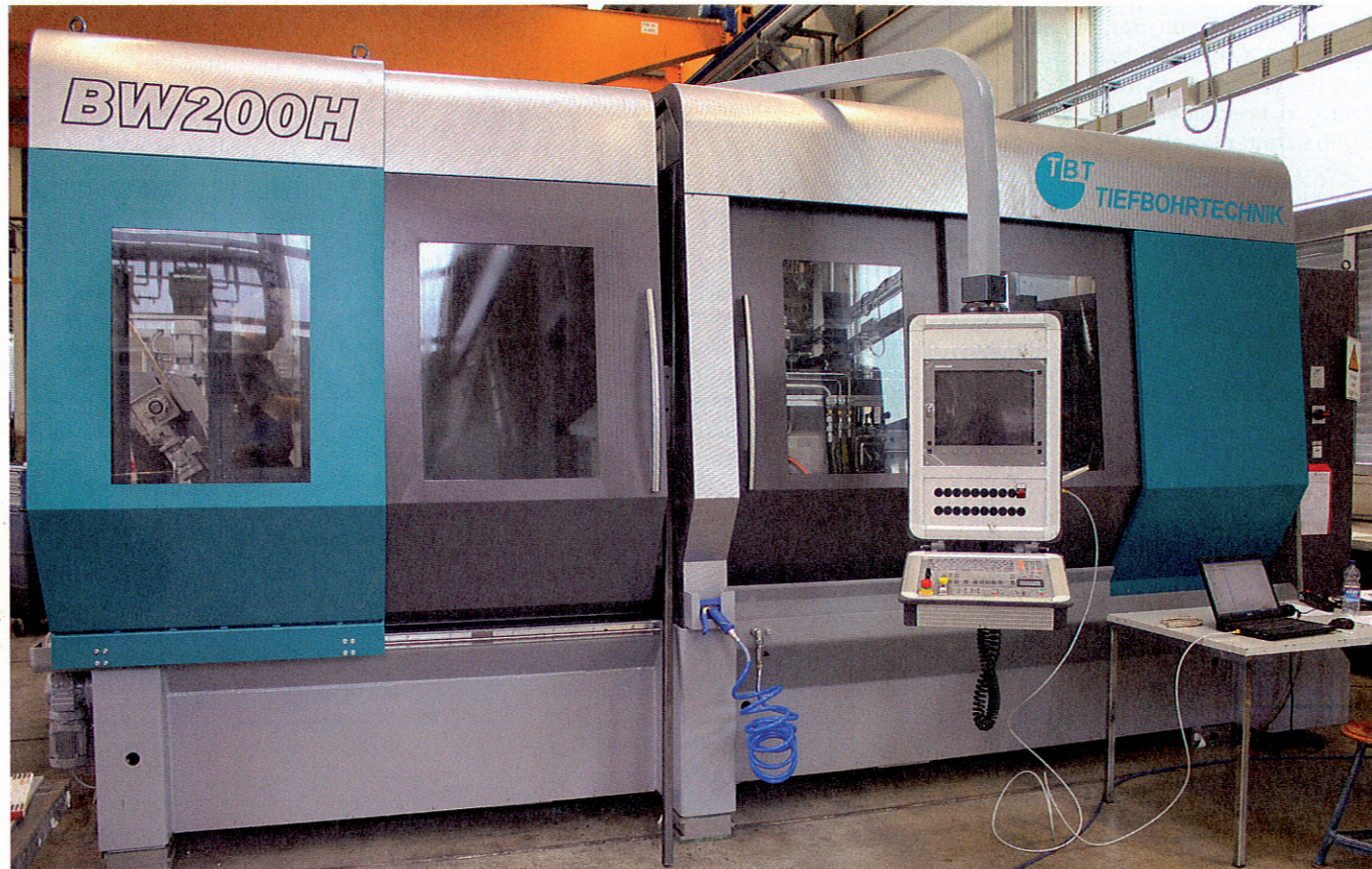
Zwei vollwertige Maschinen in einer: Die BW200H des Herstellers TBT Tiefbohrtechnik bietet Tieflochbohren bis 1000 mm und die Frästeistung eines mittleren Bearbeitungszentrums.
